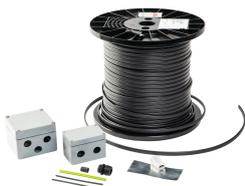
RAYCHEM C25-01 ist ein Warmschrumpf-Netzanschluss-Kit, mit dem alle RAYCHEM BSA- und BTV Begleitheizungskabel an ungefährliche Anschlusskästen angeschlossen werden können. Das CSE-05-DR-Set besteht aus Spannungsverbindung, Verbindungsgarnitur und einer wärmeschrumpfbaren Endabschlusslösung für BSA-Heizkabel. E-02-AL ist eine Endabschlusslösung mit Kaltanschlusstechnik für BSA-Heizkabel.
