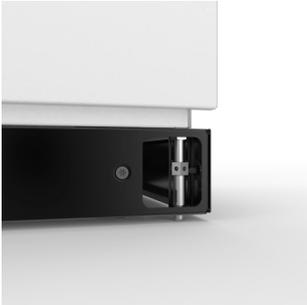
Der Einsteller wurde für die Nivellierung auf unebenen Böden am Installationsort entwickelt. Der Nivellierbereich beträgt maximal 15 mm, und der Einsteller wird auf dem montierten Schaltschrank durch das Eckstück des PF/PFS-Sockels montiert.
