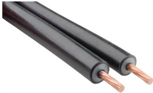
ISONV Isolierte Ableiter sind spezielle Blitzschutzableiter, die im Betrieb Impulsströmen von bis zu 200 kA ausgesetzt werden können. ISONV wurde entwickelt und getestet, um Trennungsabstände einzuhalten und Lichtbogenbildung zu vermeiden. Eine halbleiterfähige Ummantellung dient der Minimierung von Potentialgefällen bei Blitzschlag.
