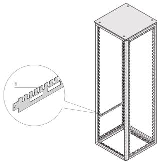
Varistar horizontale Kabelabfangschiene in der Schranktiefe. Direkt am Rahmen montiert.
