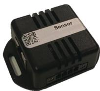
Der externe Sensor mit 2 RJ45 Steckverbindern überwacht Temperatur, Feuchtigkeit und digitale Eingänge. Bis zu 16 Sensoren können über Patchkabel in Reihe geschaltet und an einen Guardian Management Port angeschlossen werden.
