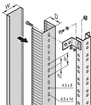
Kabelführung in seitlichen und hinteren Schrankbereichen und zur Montage an Schrankholmen, Tiefenstreben und C-Profilen.
