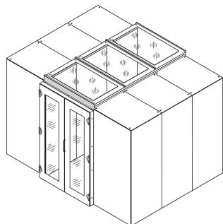
Blindplatten für unterschiedliche Einhausungshöhen, um zu vermeiden, dass an den Gangschwenktüren Luft entweicht.
