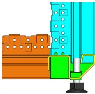
Der geschweißte Varistar CP-Rahmen ist für statische Lastanforderungen verfügbar und kann mit 19", ETSI oder Montageplatte integriert werden. Zusätzlich kann der Rahmen bei Bedarf mit Lenkrollen ausgestattet werden.
