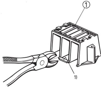
Montagewinkel für Sammelschienen oder Sammelschienenmodule sind vom Lastkreis getrennte Montageeinheiten für Erdungsschienen. Adapter mit zugewiesenen Nennströmen können vorhanden sein, die den Verbraucherabgangsleitungen den Arbeitsstrom über Kabelverbindungen zuführen.
